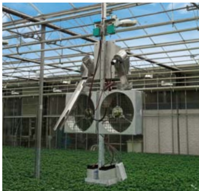
Ultralydssensorer monteres på hver side af armen og sikrer en pålidelig kollisionsbeskyttelse i drivhuset.
