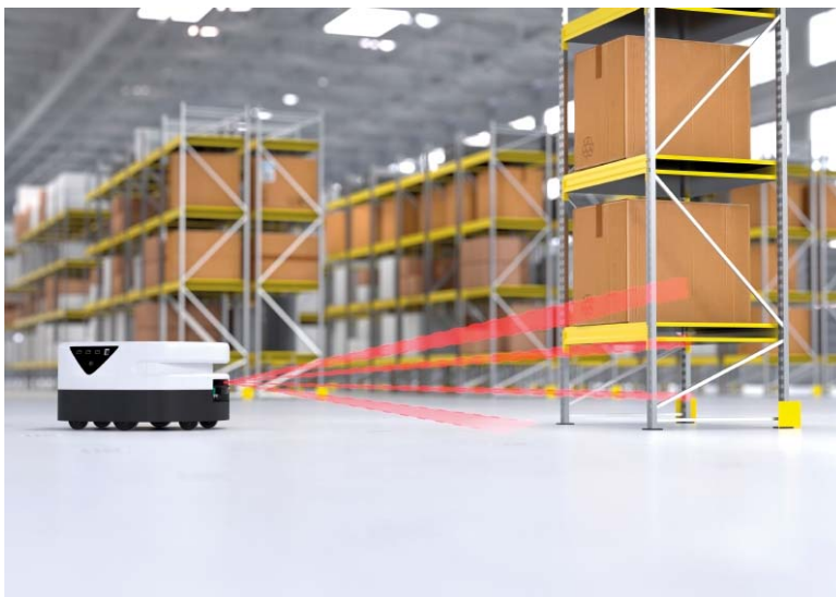
Kollisionsvermeidung und Navigationsunterstützung eines AMRs
